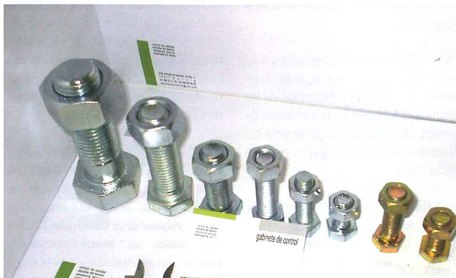
Proceso de identificación de la tornillería, para una estructura porticada de uniones atornilladas, para proceder a las labores propias de identificación de materiales dentro del Programa de Control de Calidad de una Nave Industrial
