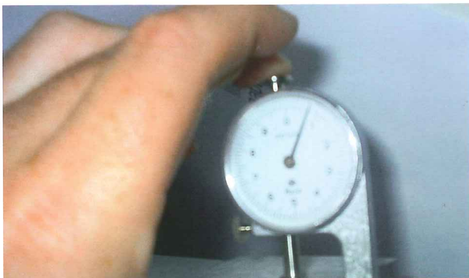
Comprobación de los espesores de las chapas de cubiertas y/o de cerramiento de una Nave Industrial, previamente a la determinación del espesor de galvanizado, una vez recepcionado el material en obra
